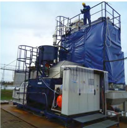
Pilote de traitement d'eau de production pétrolière en cours de tests sur un site de production de GDF Suez en Allemagne
